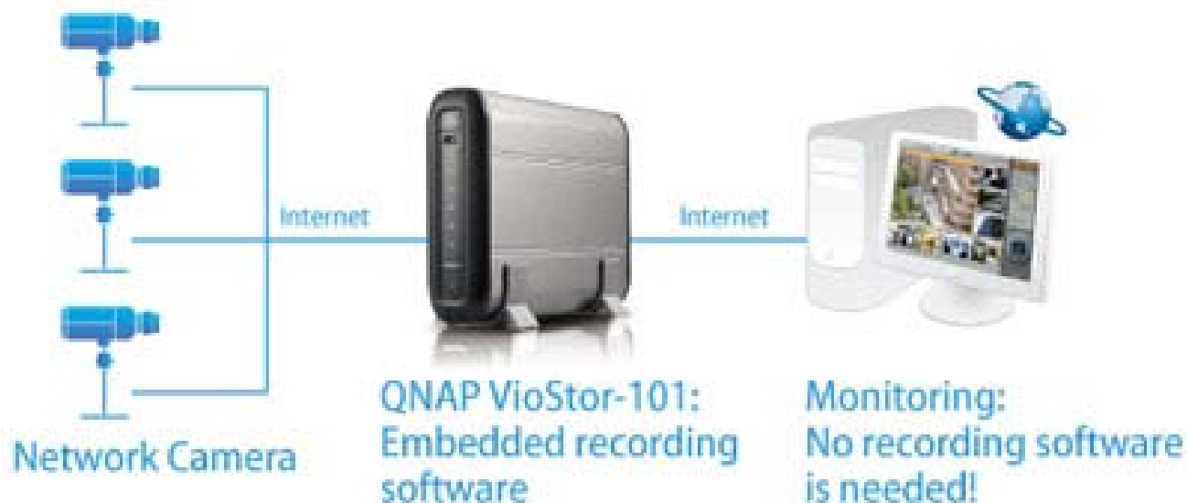
Rys.44 Schemat odbioru on-line obrazu z kamer monitorujących na komputerze, przez sieć internet.
